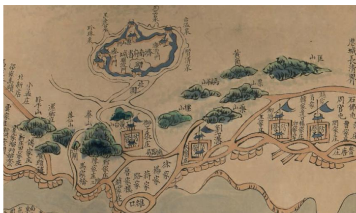
Detalle de los diques artificiales construidos en el río Amarillo, cerca de la ciudad de Jinan, en 1881. Por allí, el río estaba canalizado, pero había que añadirle diques para defender de las riadas al terreno circundante. Este plano chino lo he extraído del libro de Mostern & Horne (2021).
